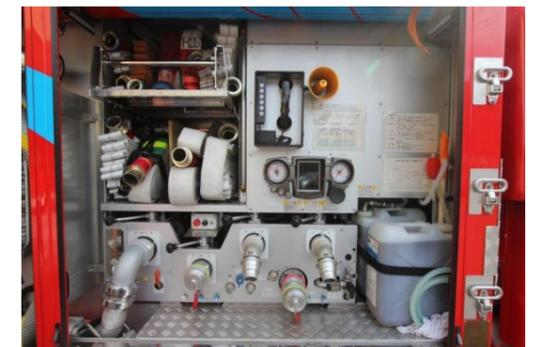
キャビン側のシャッターを開けると、ポンプの操作部と、放水口などと、圧縮空気での消火するための薬剤、各種ホースなどがあります。
