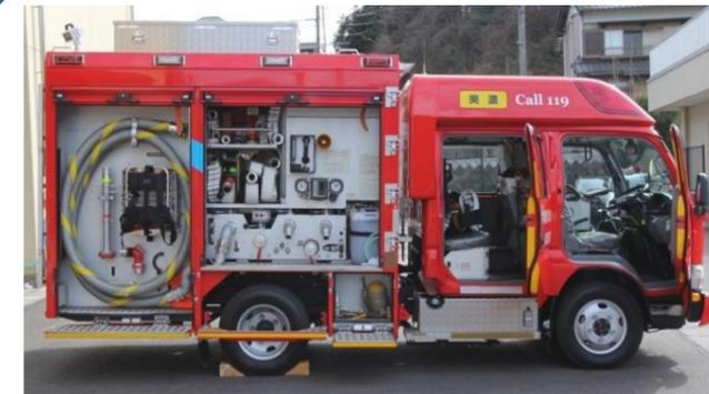
車両のシャッターを開けると様々な装置や機材があります。ポンプは左右の操作部で動かします。CAFSの薬液は左側に積載してあります。
