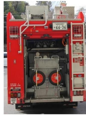
車両後部のシャッターを開けると、中にはホースカーや空気呼吸器の予備ポンペなどがあります。車両の左側には火災現場で使用するはしごが積載してあり、一番左の写真のようにして下ろします。上部に登るためのはしごが右側にあります。
