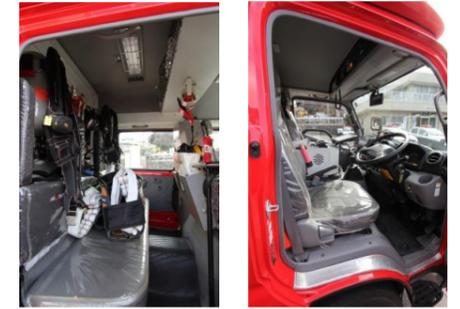
キャビンの運転席(右写真)と後部席(左写真)。後部席には空気呼吸器が積載しており、出場途中で着装できます。
