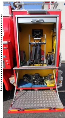
左側には吸管や投光器(ライト) 空気呼吸器などをのせています。
