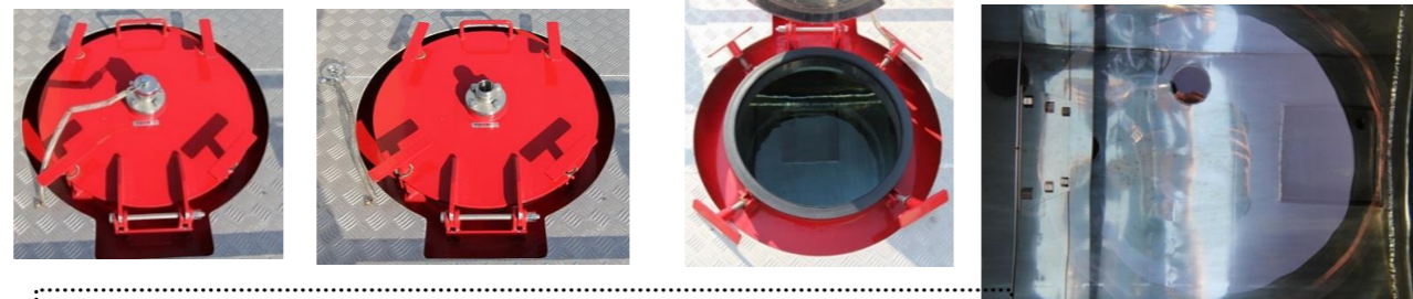
車両の上には水槽へ水を入れるための穴があります、普段は小さな穴からホースで水を入れます。大きな蓋をあけると中のきれいな水が見えます。
