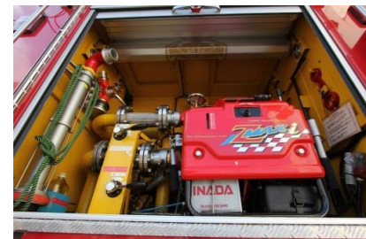
車両後方のシャッターを開くとポンプがのせてあります。ポンプを動かした時に熱がこもらないようにポンプの上の部分が開きます。(下の写真)
