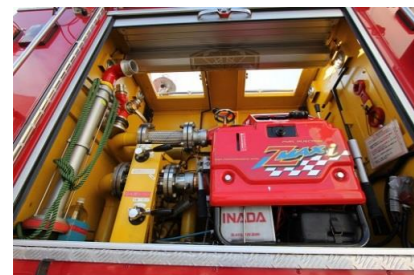
車両後方のシャッターを開くとポンプがのせてあります。ポンプを動かした時に熱がこもらないようにポンプの上の部分が開きます。(下の写真)
