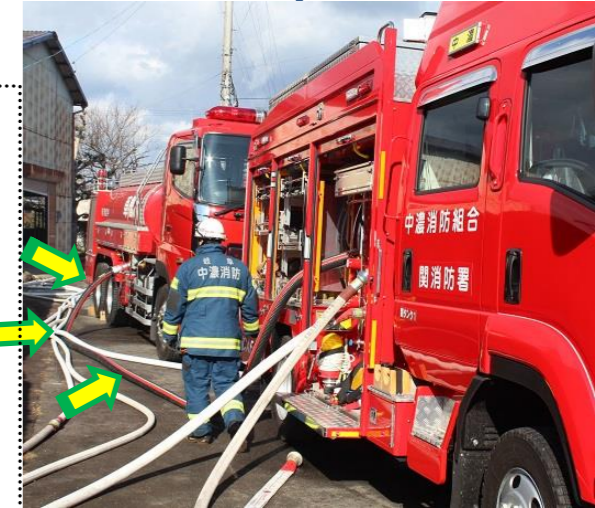
右の写真の矢印の管の中をとって、水槽車から消防車へ水を送ります。火災現場はホースでいっぱいになります。
