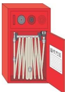
屋内消火栓設備
