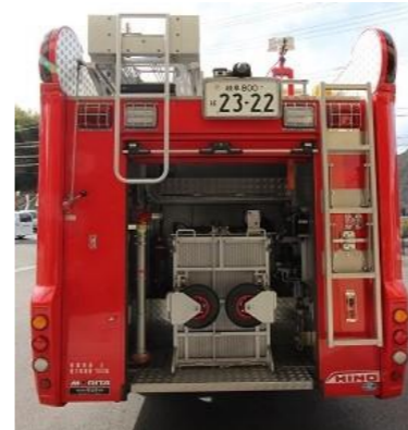
車両後部のシャッターを開けると、中にはホースカーや空気呼吸器の予備ポンペなどがあります。車両の左側には火災現場で使用するはしごが積載してあり、一番左の写真のようにして下ろします。上部に登るためのはしごが右側にあります。
