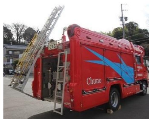
車両後部のシャッターを開けると、中にはホースカーや空気呼吸器の予備ポンペなどがあります。車両の左側には火災現場で使用するはしごが積載してあり、一番左の写真のようにして下ろします。上部に登るためのはしごが右側にあります。
