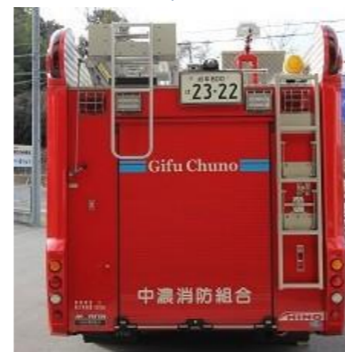
車両後部のシャッターを開けると、中にはホースカーや空気呼吸器の予備ポンペなどがあります。車両の左側には火災現場で使用するはしごが積載してあり、一番左の写真のようにして下ろします。上部に登るためのはしごが右側にあります。
