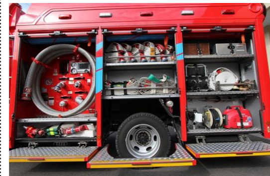
車両の側面にはそれぞれ、シャッターが3枚あります。写真のとおり、ポンプの操作部やホース、発電機、筒先などの各種機材が積載してあります。
